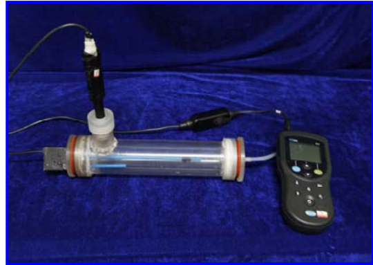
自行研制的循环密闭式鱼类临界氧压测定仪
