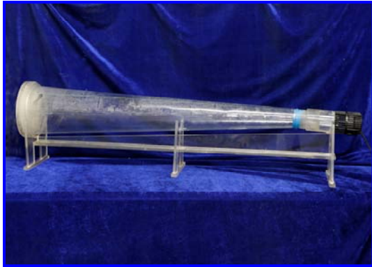
自行研制的鱼类流速梯度选择观测装置
