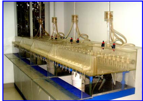
自行研制的具投饵孔的流水式鱼类代谢仪
