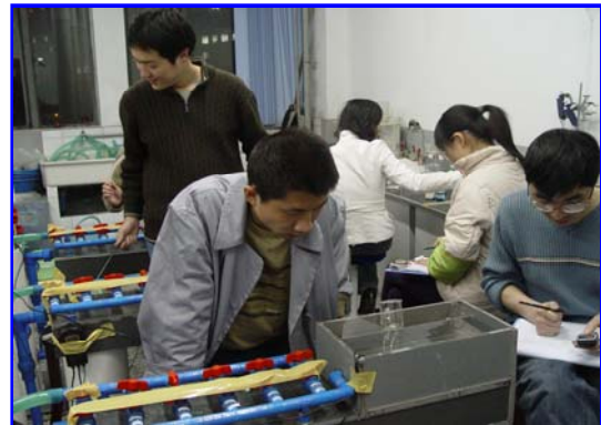
实验室成立初期利用自行研制专用仪器开展鱼类游泳能力测定的实验
